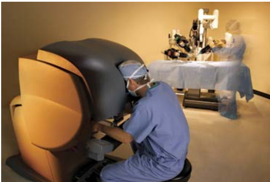
Konsollen hvorfra robotten styres
